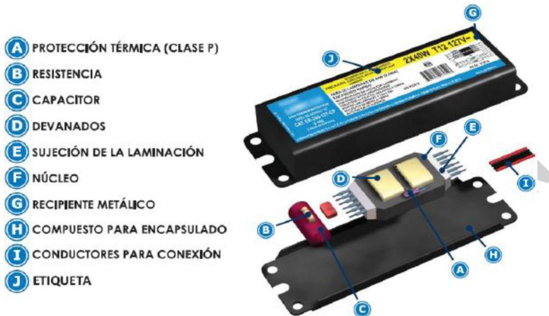
FIGURA XVIII: COMPONENTES DE UN BALASTRO
